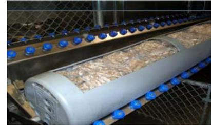
Viande tranchée et emballée, en place et prête pour le traitement dans une machine de transformation à haute pression.
